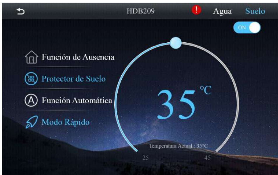
Fig. 5.6 Control de suelo radiante
