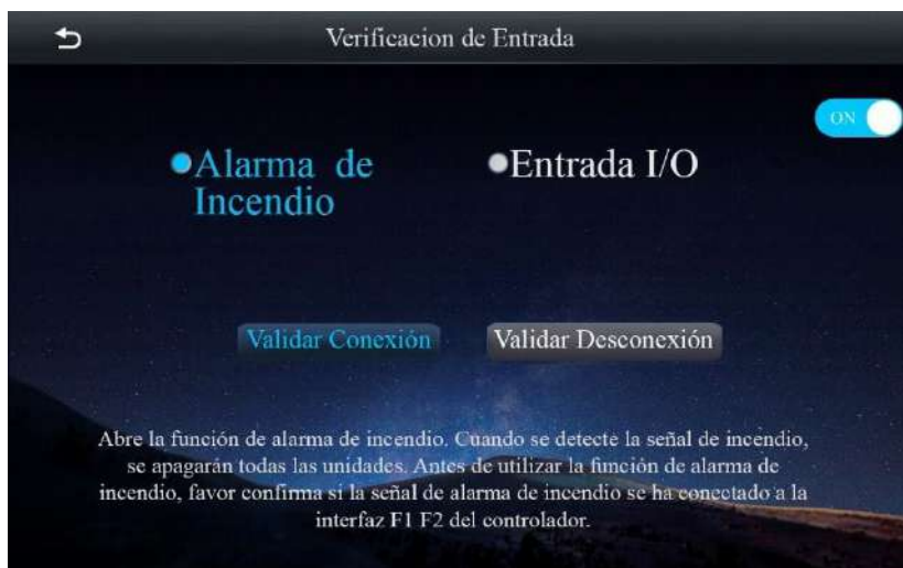
Fig. 5.15 Página de alarma de incendio
